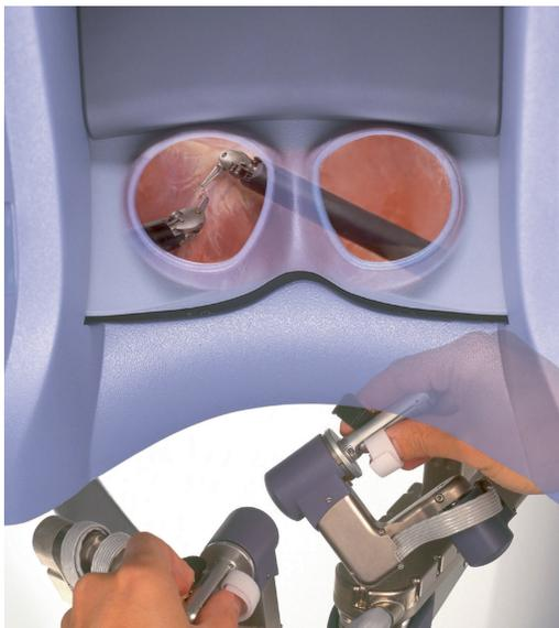
**Figure 1-3** Système optique 3D et axe vision-mains.
