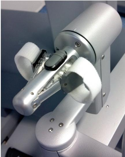
**Figure 1-6** Débrayage des instruments et mise au point depuis les manettes du robot da Vinci® « Si ».
