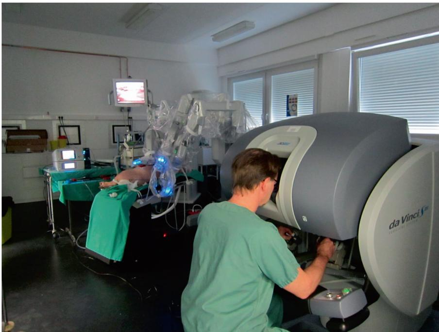
**Figure 3-1** Installation d'une intervention de télé-microchirurgie endoscopique chez le cochon. Au premier plan, l'opérateur manipule les instruments à distance du champ opératoire à partir de la console chirurgicale du robot da Vinci®.
