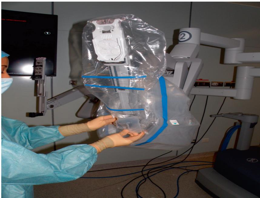
**Figure 10-4** Habillage d'un bras du robot et préparation de la mise en place de l'instrument.
